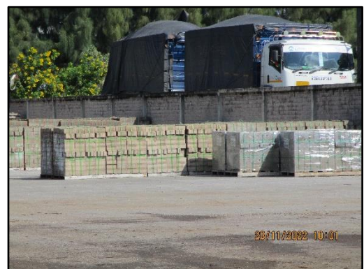
ภาพที่ 2.26 การนำหลัก 3R มาประยุกต์ใช้ (อิฐ Pro Block จาก Fly Ash)
