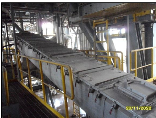
ภาพที่ 2.11 ระบบสายพานลำเลียงเก่าแบบปิดครอบ
